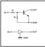
$R_1=1.0k\Omega / R_2=10k\Omega$
